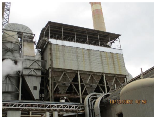
รูปที่ 2 - 10 ระบบดักจับฝุ่นแบบถุงกรอง (Bag Filter)
