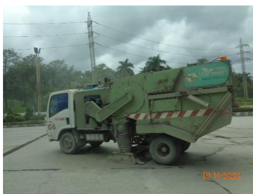
รูปที่ 2 - 71 รถขนส่งขยะชุมชนติดตั้งกล่องรับน้ำเสีย
