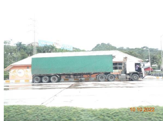
รูปที่ 2 - 6 รถที่ใช้ในการขนส่งเชื้อเพลิง ต้องเป็นรถบรรทุกแบบปิด
